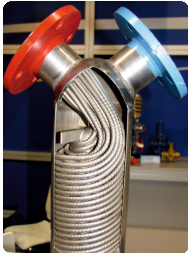
Теплообменник змеевикового типа в разрезе
