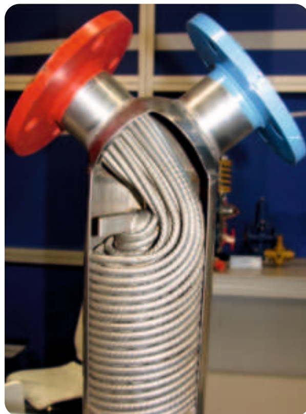
Теплообменник змеевикового типа в разрезе
